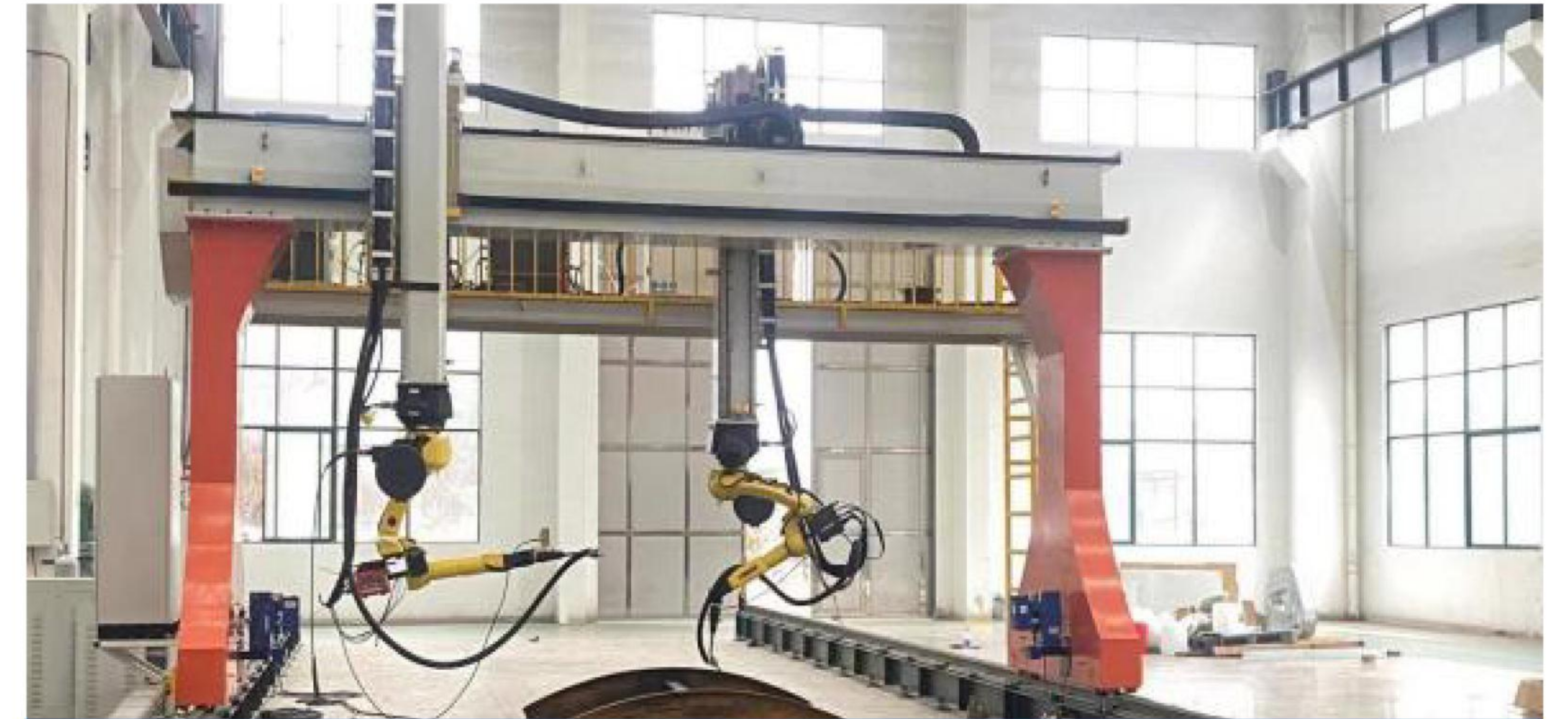
روبوت اللحام الأوتوماتيكي بالكامل ذو 9 محاور 9-axis fully automatic welding robot
