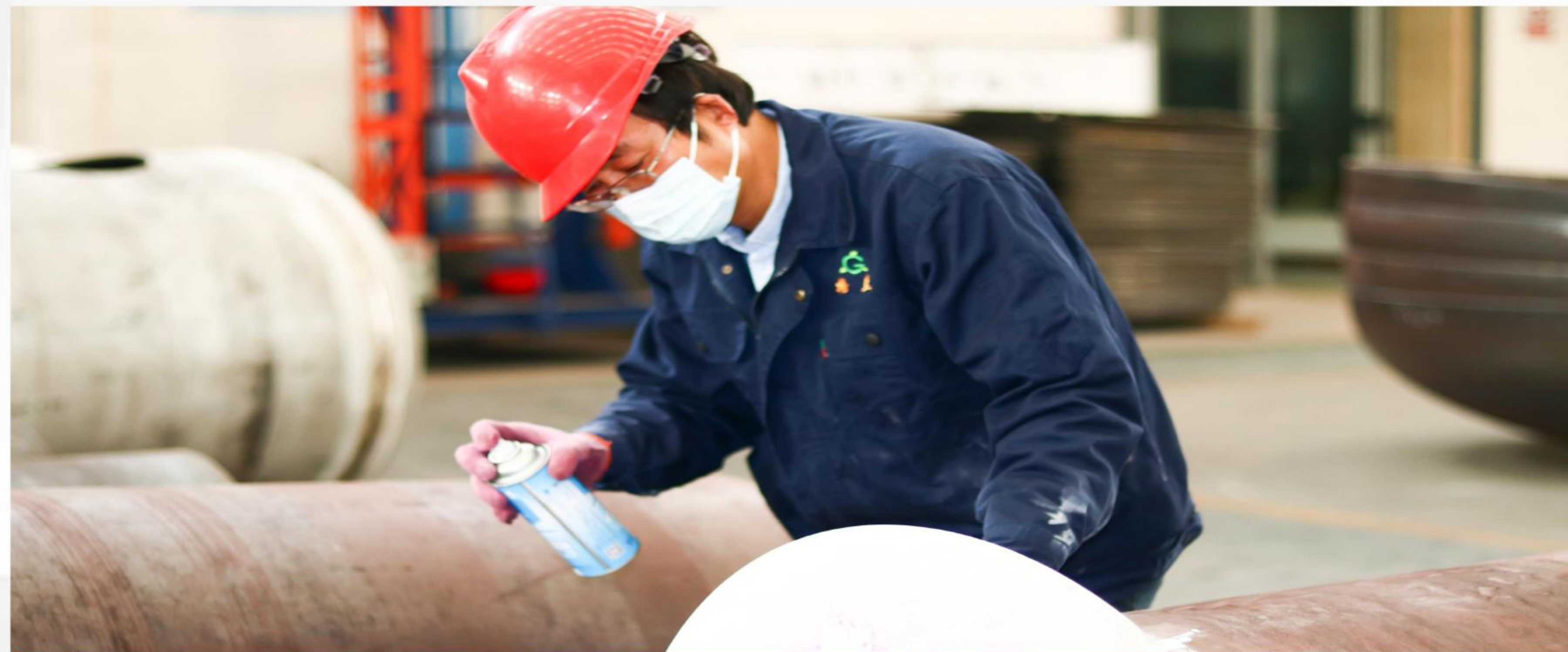
التناضح Penetrant testing
