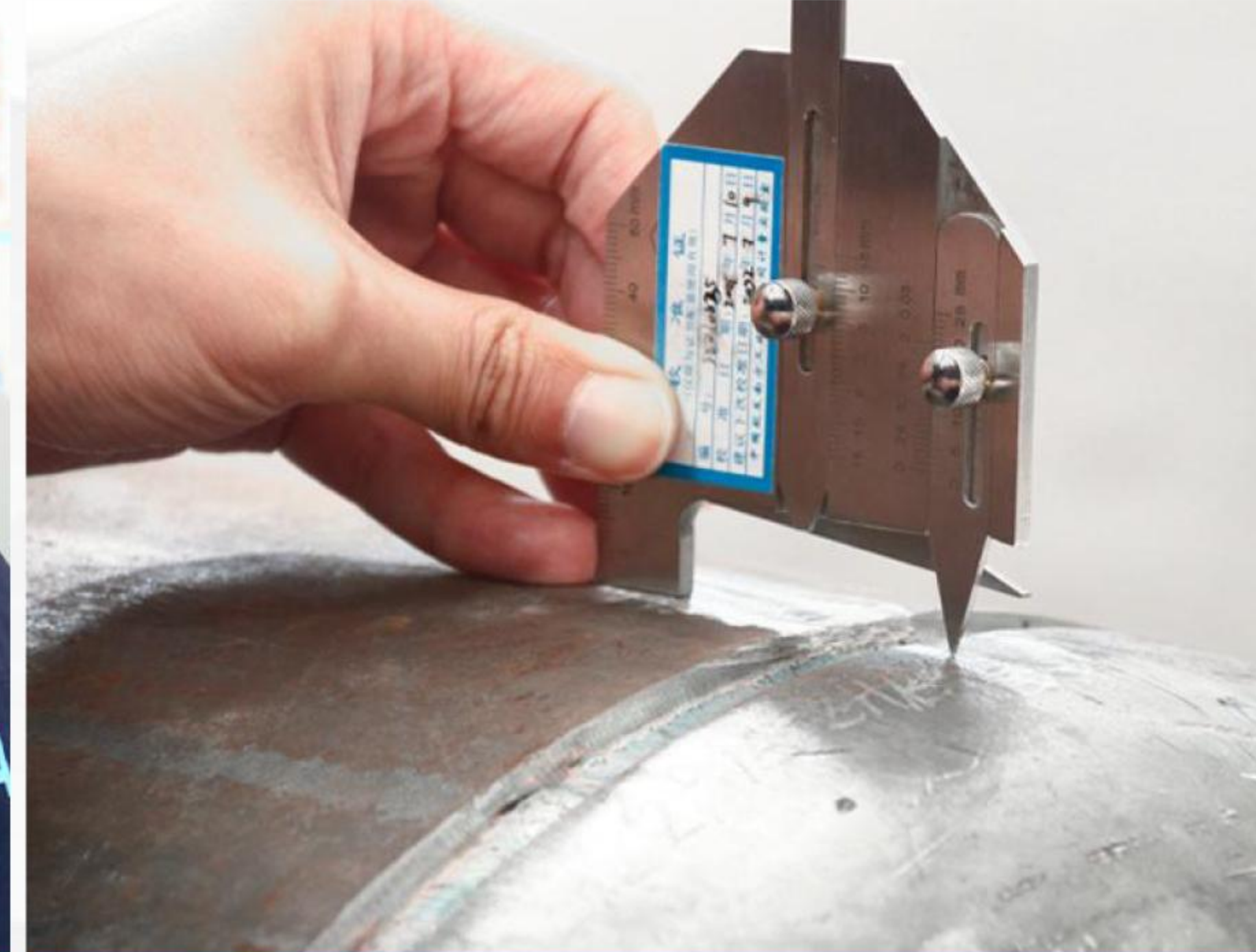
فحص اللحام Weld inspection
