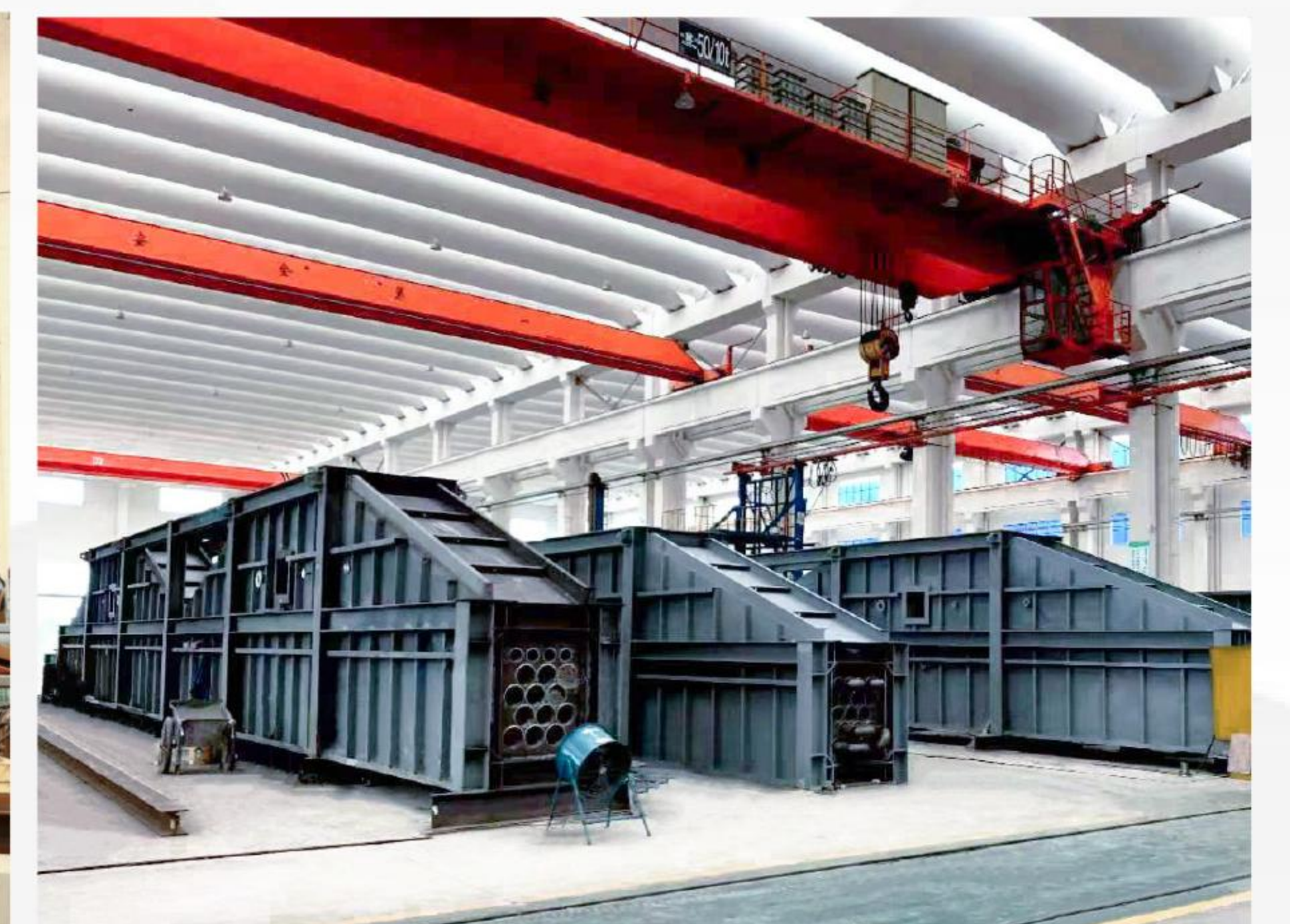
وحدة قسم الحمل الحراري Convection section module
