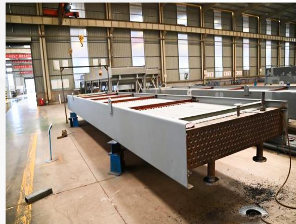
空冷器 Air cooler
