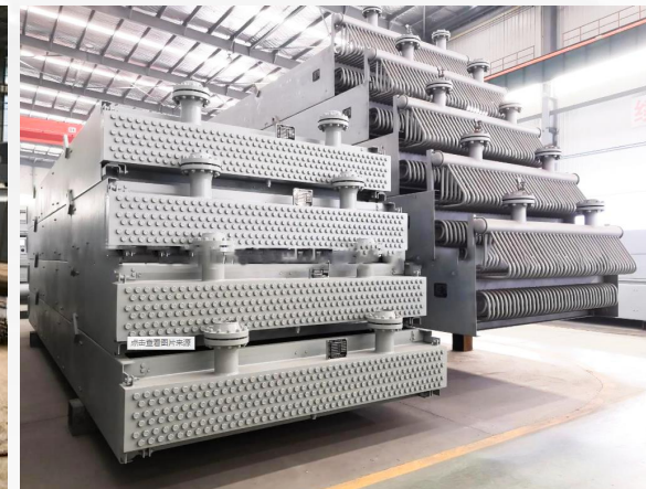
空冷器 Air cooler
