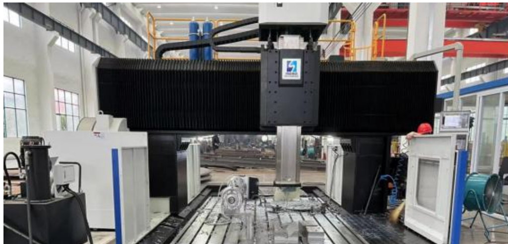
数控龙门加工中心 CNC gantry machining center
